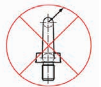
Schaubild: Zugbelastung des Heberingbolzens
