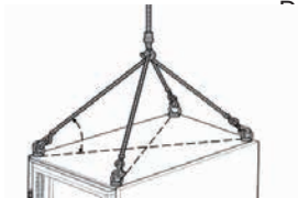
Schaubild: Kabelwinkel beim Krantransport
