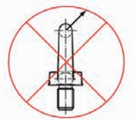
Schaubild: Zugbelastung des Heberingbolzens
