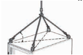
Schaubild: Kabelwinkel beim Krantransport
